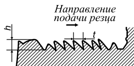
Рис. 9.6 Вид неровности поверхности вала: глубина h = 0,7...0,8 мм; шаг t = 1,6...2 мм.
